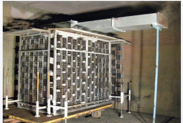
Ćelija u procesu testiranja otpornosti na luk (arc proof)
