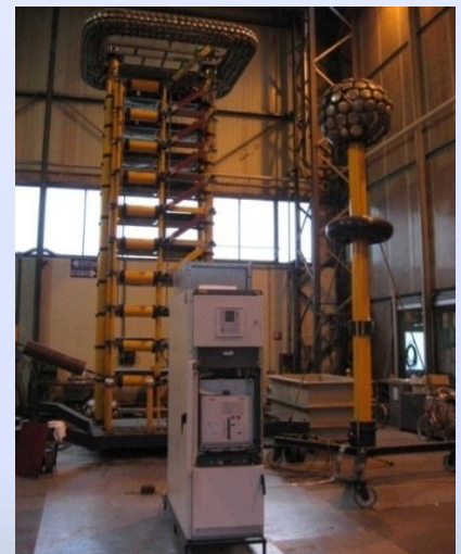
Ćelije u postupku testiranja otpornosti na luk (arc proof)
