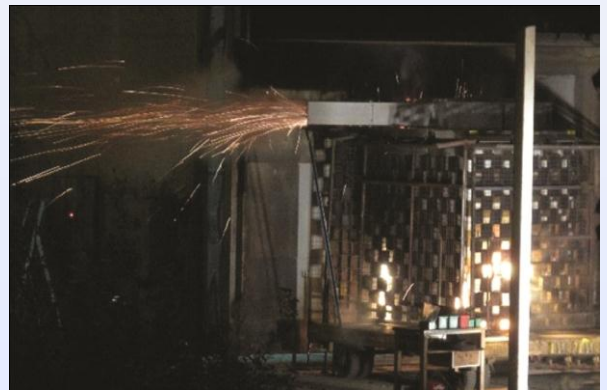
Ćelije u postupku testiranja otpornosti na luk (arc proof)
